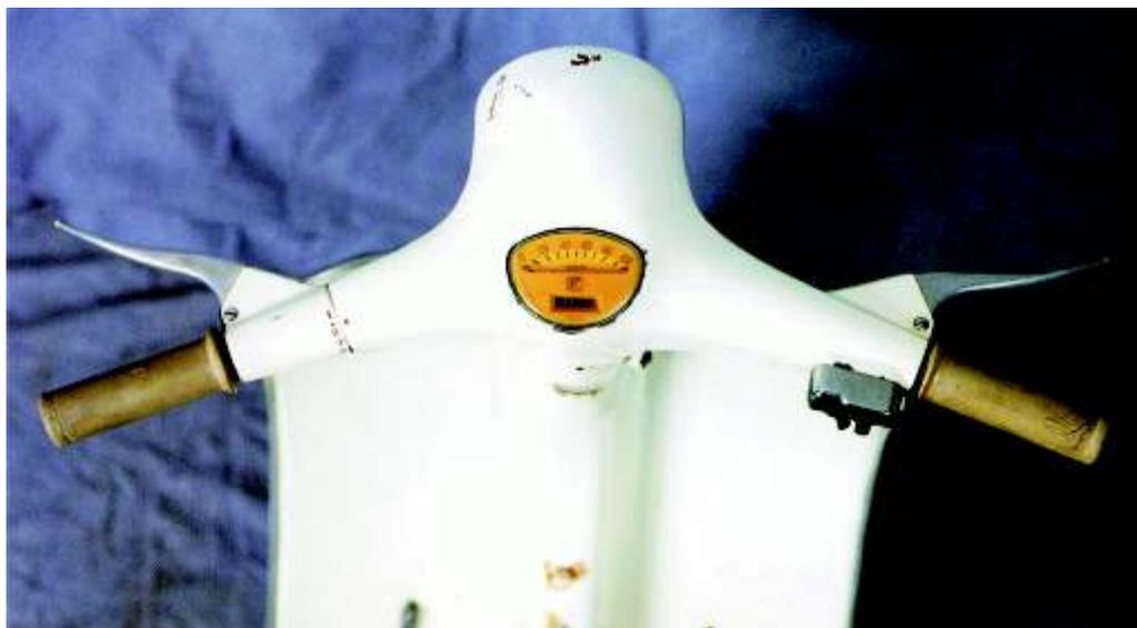
Il contachilometri è di nuovo disegno ed è scalato a 100 km/h.
