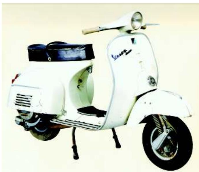
“Il manubrio è di nuovo disegno, in fusione di alluminio con la predisposizione degli attacchi per il parabrezza.
