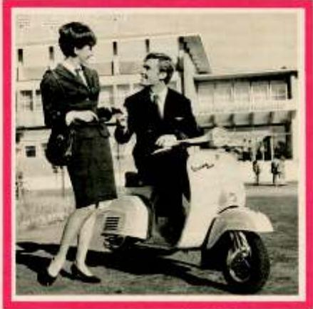
Cilindrata: 123,4 cc. Velocità: 85 Km/h. Consumo: 1 lit. di miscela al 2% per 47 Km. Tempo occorrente per percorrere 1 Km. con partenza da fermo: 47"9. Tempo occorrente per raggiungere la velocità di 75 Km/h con partenza da fermo: 18"5. Colore: verde chiaro.
