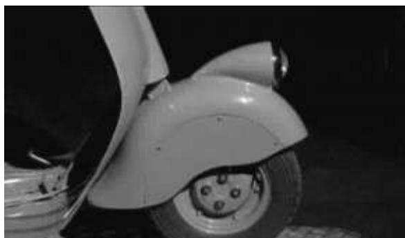
La ruota anteriore mostra un elemento in lamiera scomponibile, mediante viti, per facilitare la sostituzione della ruota in caso di foratura. Il faro, costruito dalla Feme è da 85 mm e la lampada di posizione è di 3 W e quella di profondità da 15 W: impianto elettrico 6 V. Notare la leva del freno posteriore messa a sinistra del guidatore.
