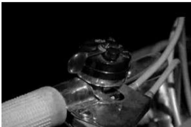
Sul lato destro del manubrio, in posizione comoda per il guidatore, è posizionato il blocco di comando che aziona sia il faro anteriore che le luci posteriori, oltre al pulsante del clacson: la tromba del suddetto è posta sotto la sella. (2)
